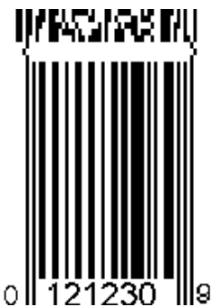
Figura 7.8.6.3-2. Esempio di simbologie miste (GTIN codificato in UPC-E, data di scadenza in Composite)
