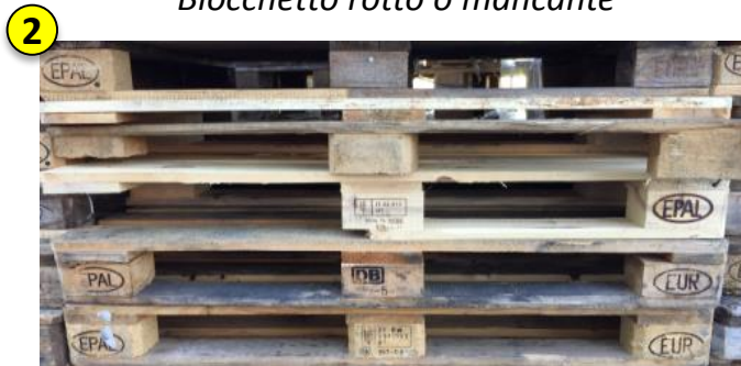
2 Blocchetto rotto o mancante
